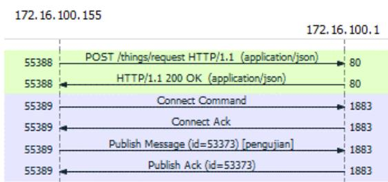
Gambar 23. Network flow autentikasi MQTT
